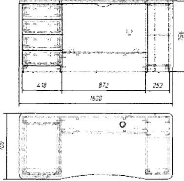
*Верхня робоча поверхня (стільниця) робочого столу викладача повинна бути виготовлена з ламінованого ДСП світло-сірого кольору, товщиною не менше 32 мм, мати округлення кутів з правого та лівого боку; торець поверхні оздоблений крайкою шириною не менше 32 мм та товщиною не менше 2 мм, чорного кольору.*
