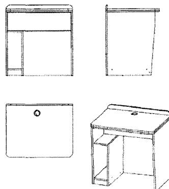
*Робоча поверхня (стільниця) повинна бути виготовлена з ламінованого ДСП світло-сірого кольору, товщиною не менше 32 мм. Торець поверхні оздоблений крайкою шириною не менше 32 мм та товщиною не менше 2 мм, чорного кольору.*
